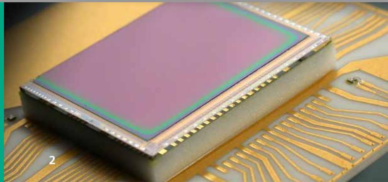
1 *Bi-spektrale Infrarot-Detektoren können Bedrohungen vom Flugzeug aus zuverlässig erkennen.*
